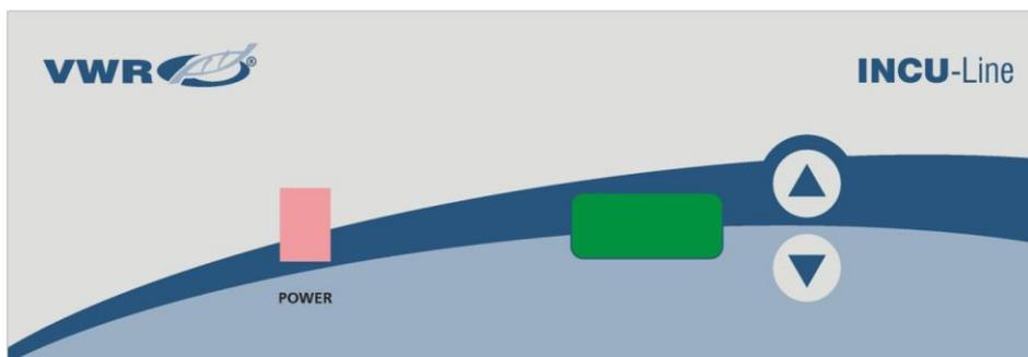
POWER - interrupteur d'alimentation: Pour le tournage de l'incubateur ON et OFF. Le voyant Power s'allume lorsque la machine est sous tension.
